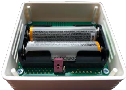
Jumperstellung für Heizkreis 1
