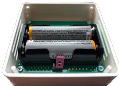
Jumperstellung für Heizkreis 2
