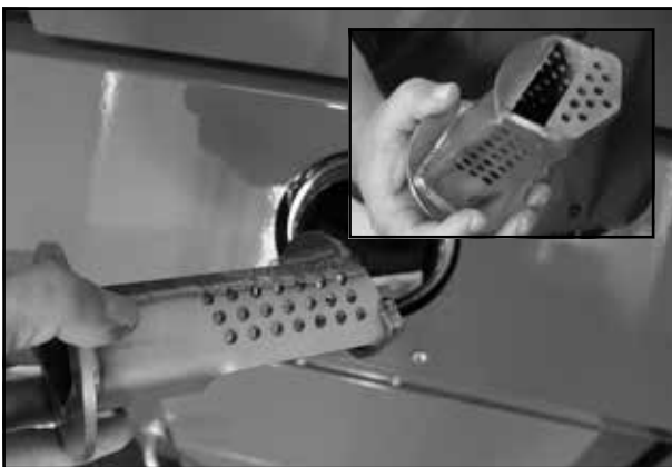
Die Zünd- und Blindkammer herausnehmen
