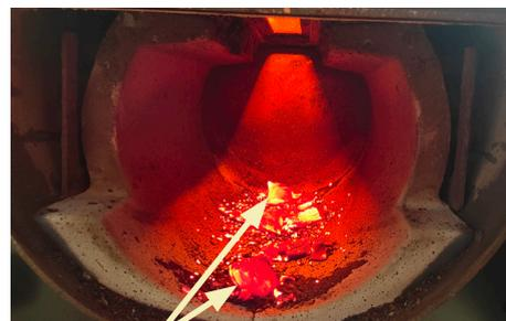
Größere Stücke müssen nach dem Nachlegen aus der Brennkammer entfernt werden.
