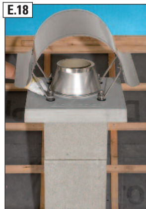
Meidingerscheibe aufsetzen, Sicherungsring aus Edelstahl (D) einbringen und mit Mutter M12 aus Edelstahl (E) kraftschlüssig verschrauben. Hutmutter aus Edelstahl (F) aufschrauben.
