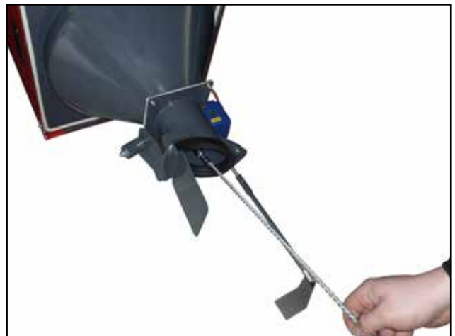
Bürsten des Siebs durch die Brennstoff-Ausschüttöffnung
