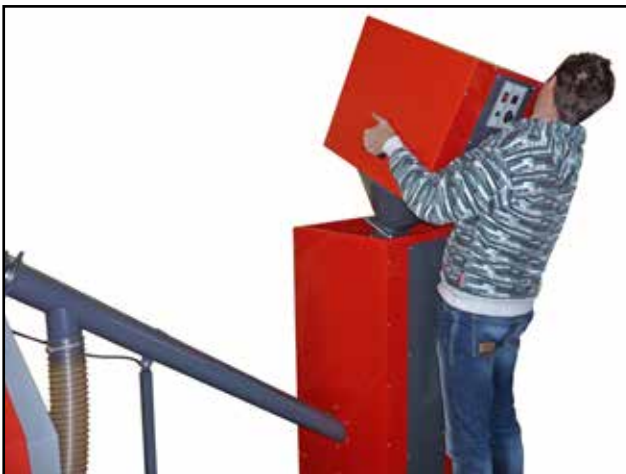
Abheben der pneumatischen Förderanlage vom Ausgleichbehälter
