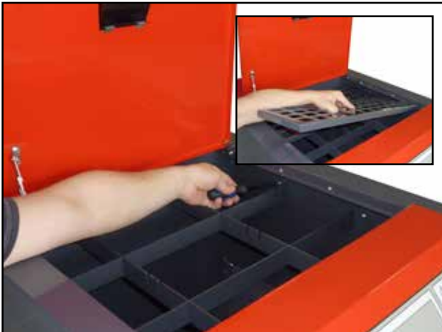
Entfernen der oberen Schutzgitter und Abschrauben des Haltergitters aus dem Pelletsbehälter
