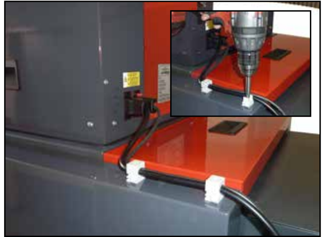
Befestigung von Kabelhalter zur Seitenverkleidung
