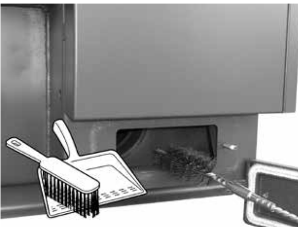
Vorführung der Reinigung des Rauchkanals mit Drahtbürste.
