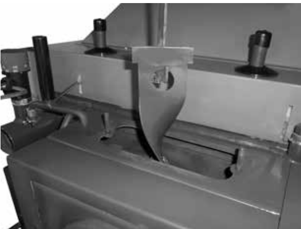
Ausziehen von Abgasbremser bei der Reinigung unter im hinteren Putzdeckel im hinterem Abgaskanal - KC35S
