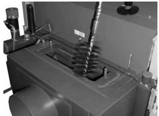
Vorführung der Reinigung des Rauchkanals mit Drahtbürste.
