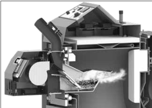
Die Flammenlänge ist optimal vor der Kesselrückwand 1 - 3 cm einzuhalten.
