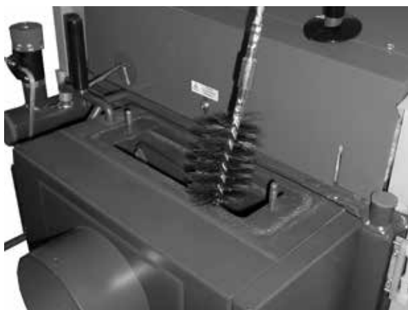
Vorführung der Reinigung des Rauchkanals mit Drahtbürste.
